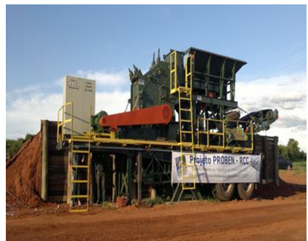
FIGURA 13: Equipamento de beneficiamento de resíduos da construção civil. FONTE: CIVAP, 2012.
