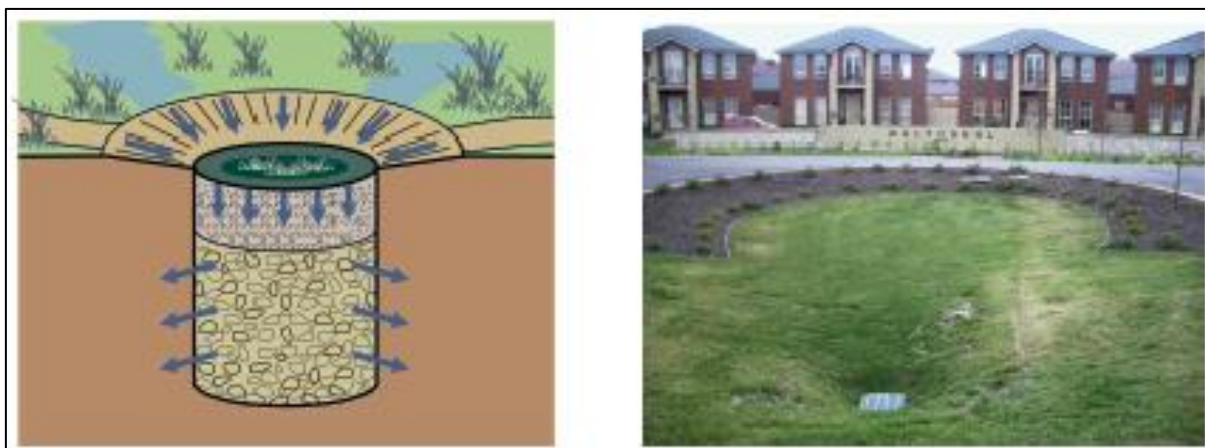
Figura 1.7 – Exemplo de poço de infiltração
