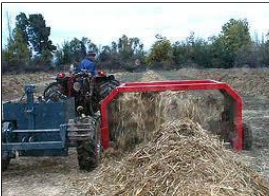
Figura 1.14 – Reviradeira de leira de compostagem acoplada a trator Fonte: Ministério do Meio Ambiente (BRASIL, 2010).
